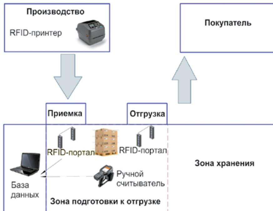
Рисунок 2. Принципиальная схема RFID-технологии
