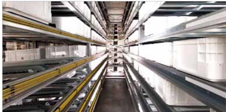
следует принципу целостности решения в отношении эффективности. Новая челночная система позволяет достичь более высокой плотности хранения, что означает большее количество складских мест при одинаковом энергопотреблении. OSR Shuttle™ Eco делает возможным снижение затрат на одно складское место, оптимизировав при этом производительность при тех же затратах электроэнергии.
