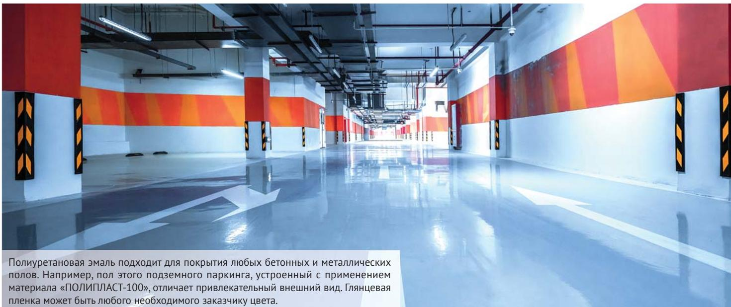
Полиуретановая эмаль подходит для покрытия любых бетонных и металлических полов. Например, пол этого подземного паркинга, устроенный с применением материала «ПОЛИПЛАСТ-100», отличается привлекательный внешний вид. Глянцевая пленка может быть любого необходимого заказчику цвета.
