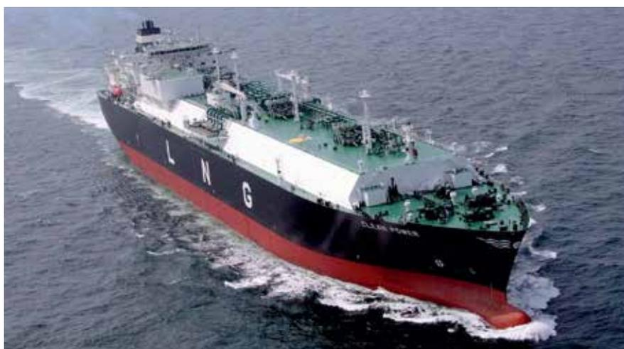
Рисунок 3. Танкер СПГ мембранного типа.
