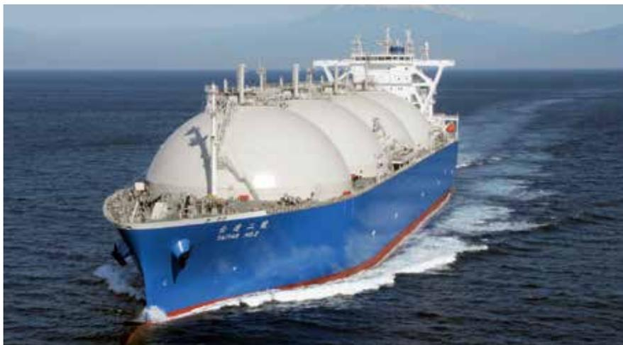
Рисунок 2. Танкер СПГ со сферическими грузовыми танками.
