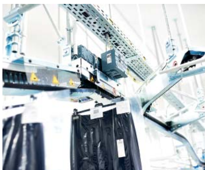
Система Roll Adapter от Dürkopp идеально подходит для транспортировки и матричной сортировки висящих товаров
