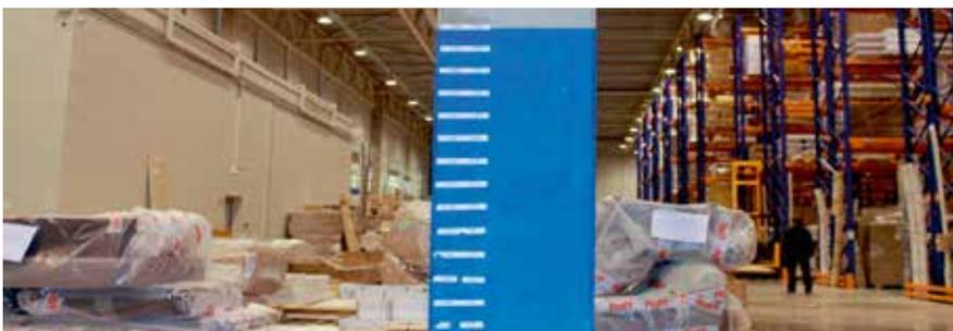
Рисунок 4. Для оперативности определения высоты поддона на колонны склада наклеивают высоотомеры (линейки) со штрихкодами, соответствующими высоте
