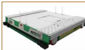
Именно эти фото-сенсоры позволяют шаттлу осуществлять транспортировку и размещение паллет различной глубины в канале.
