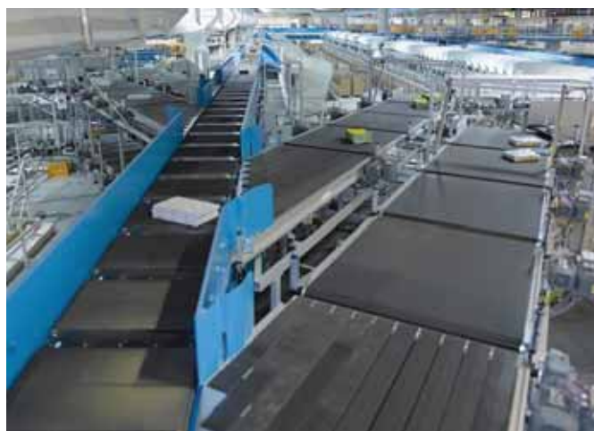
Горизонтальная система Cross-Belt Sorter INTERROLL
