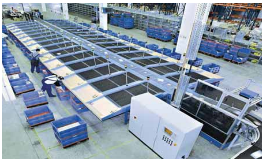
Вертикальная система Cross-Belt Sorter INTERROLL
