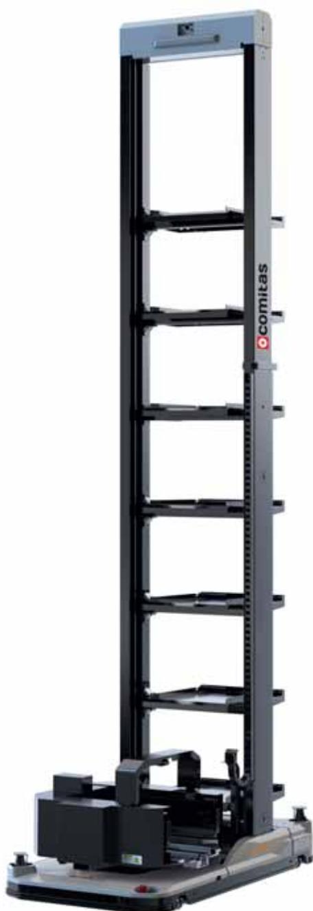
ляет перемещать как стеллажи, так и палеты. Современная система навигации выбирает оптимальный маршрут движения по складу, а датчики предотвращения столкновения обеспечивают безопасность персонала и сохранность грузов.
