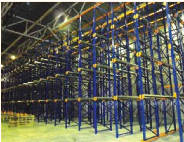
**Глубинные стеллажи.** Их основное отличие – специфический тип загрузки (в продольной плоскости). Выделяют два вида глубинных стеллажей, ориентированных на разные типы продукции. *Набивные стеллажи* используются для грузов с неограниченным сроком годности, что позволяет осуществлять все погрузочно-разгрузочные операции с одной стороны. *Проходные стеллажи* ориентированы на скоропортящуюся продукцию, погрузка и разгрузка которой осуществляется с разных сторон.
