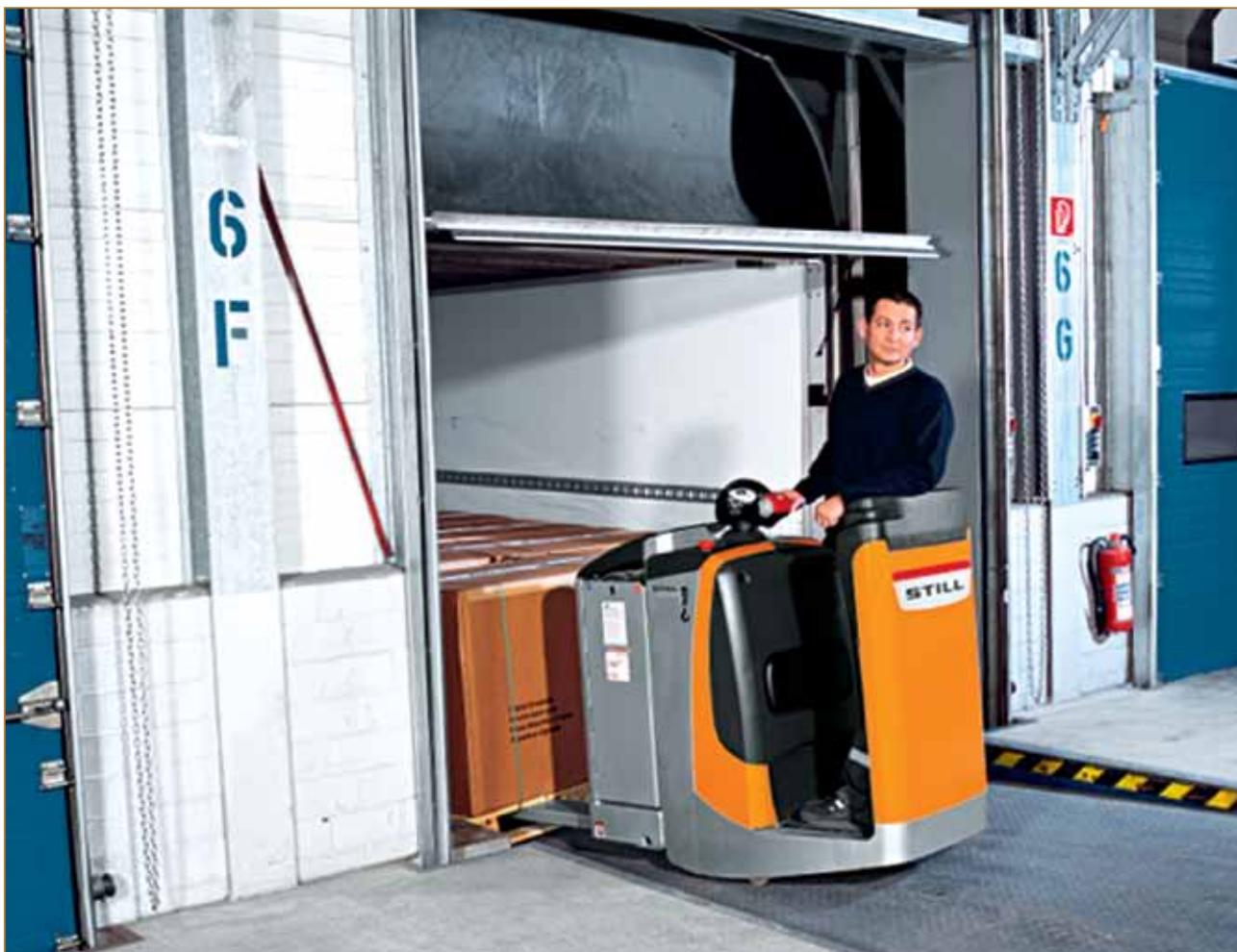
На коротких расстояниях оптимальна эксплуатация двухуровневой подъемной тележки. Скорость движения EXD достигает до 6 км/ч. Ширина прохода с грузом составляет 2,1 м. Для более значительных дистанций рекомендуется использовать EXD-SF с платформой для оператора. Двухуровневая тележка EXD-SF способна поднимать поддоны на высоту до 2924 мм.
