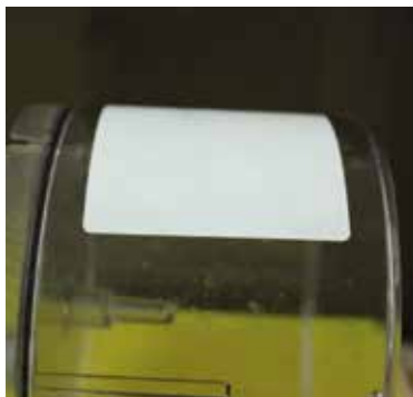
Термоэтикетка с защитным покрытием, нанесенная на пластик при температуре 18 °С
