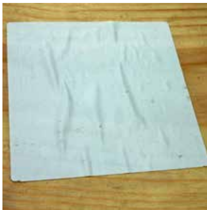
Термоэтикетка с защитным покрытием, нанесенная на пластик при температуре 18 °С
