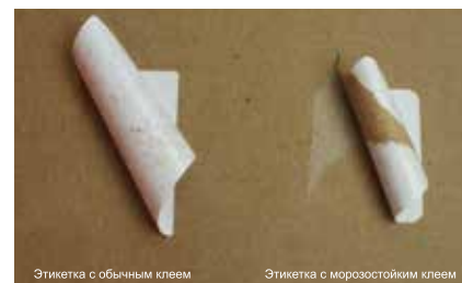
Обе этикетки сняты в тех же условиях через 15 минут после нанесения.
