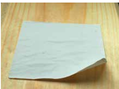
Неразглаженная этикетка после однократной транспортировки в автомобиле Источник: фото авторов
