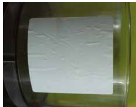
Термоэтикетка с защитным покрытием после воздействия высокой влажности в течение 12 ч. при температуре 15–18 °С
