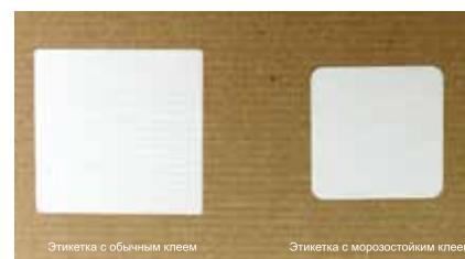
Этикетки с обычным и морозостойким клеем. Нанесены на картон при температуре -20^{\circ}\text{C}
