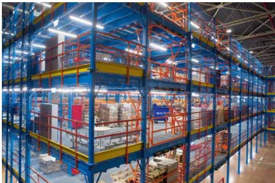
Косметический центр оборудован пятиуровневым классическим мезонином с отдельными зонами приемки и обработки заказов
