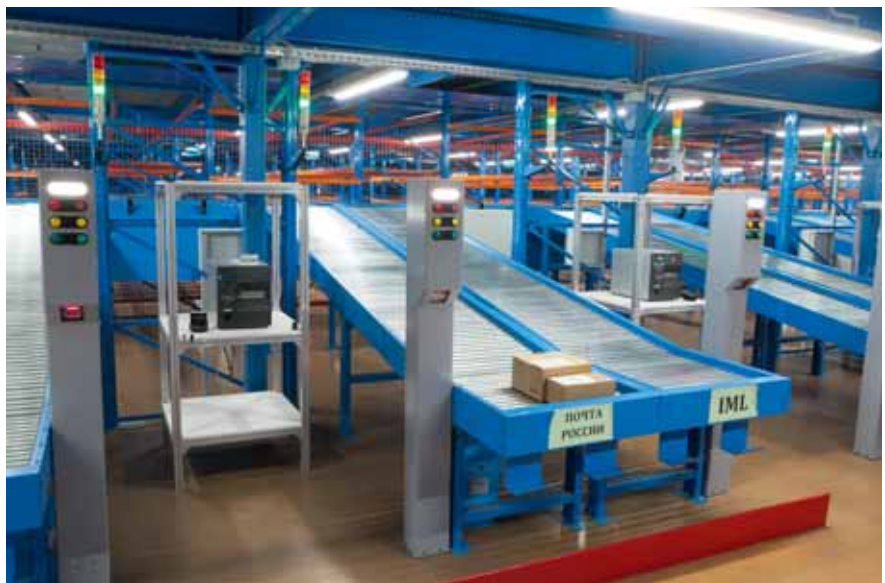
Каждая физическая цель сортера оборудована колонной со световым управлением Источник: FM Logistic
