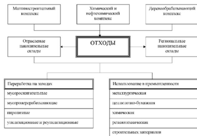
Рис. 3 Укрупненная схема движения производственных отходов в межотраслевом масштабе
