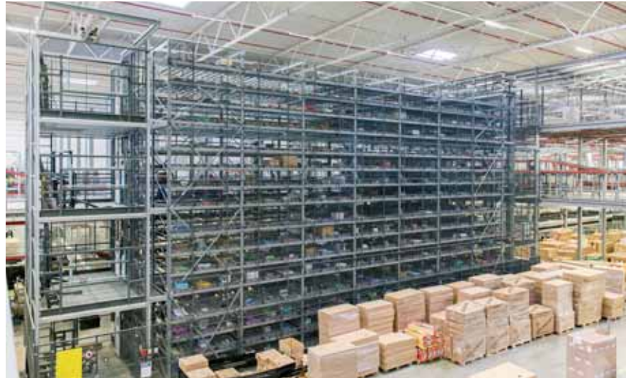
Товары для конечных клиентов консолидируются и хранятся в буфере OSR Shuttle™. Для упаковывания OSR Shuttle™ выгружает товар в правильной последовательности.
