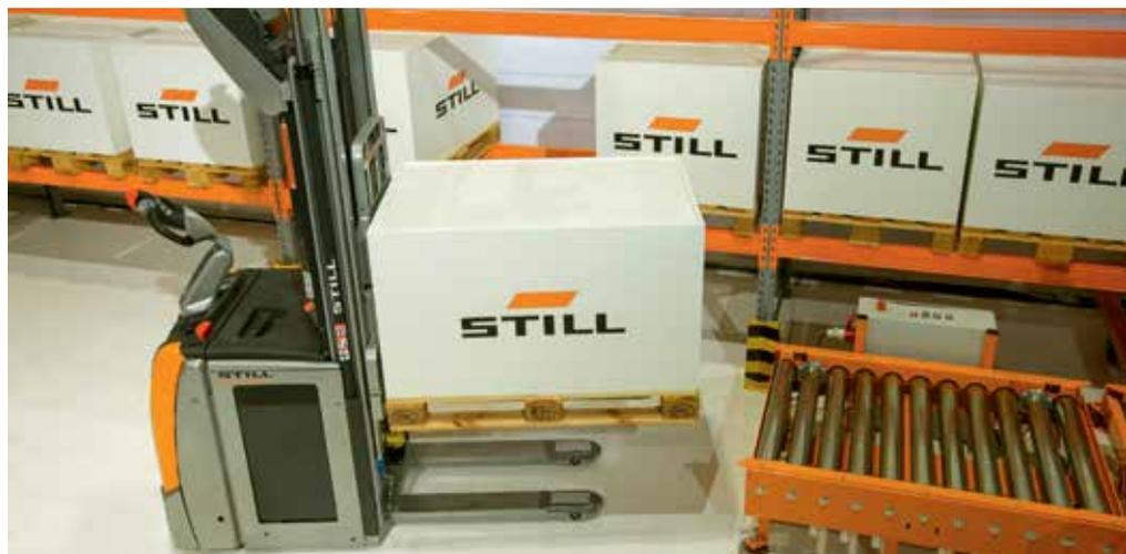
жается с помощью транзитной станции. На следующей станции Е-рама, которая теперь свободна, принимает пустую паллету таким же образом. Когда логистический поезд объезжает все станции на линии, доставив загруженные паллеты и забрав пустые, он возвращается на загрузочную станцию, разгружает пустые паллеты и получает новые, уже загруженные для следующего цикла.
