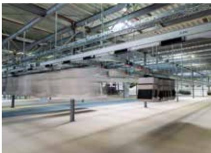
Матричная система сортировки обеспечивает эффективное автоматическое регулирование последовательности работы транспортировочных карманов
